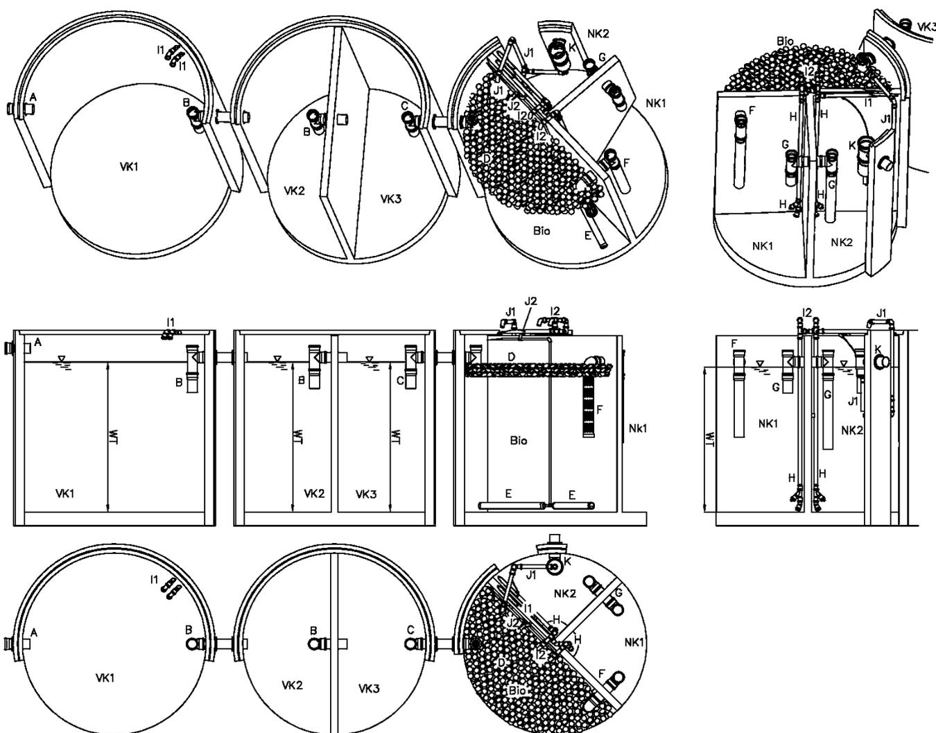
Nachrüstatz Typ Picobells für den Einbau in bestehende Abwasserbehandlungsanlagen zur Herstellung von Kleinkläranlagen für 4 bis 50 EW; Ablaufklasse C
