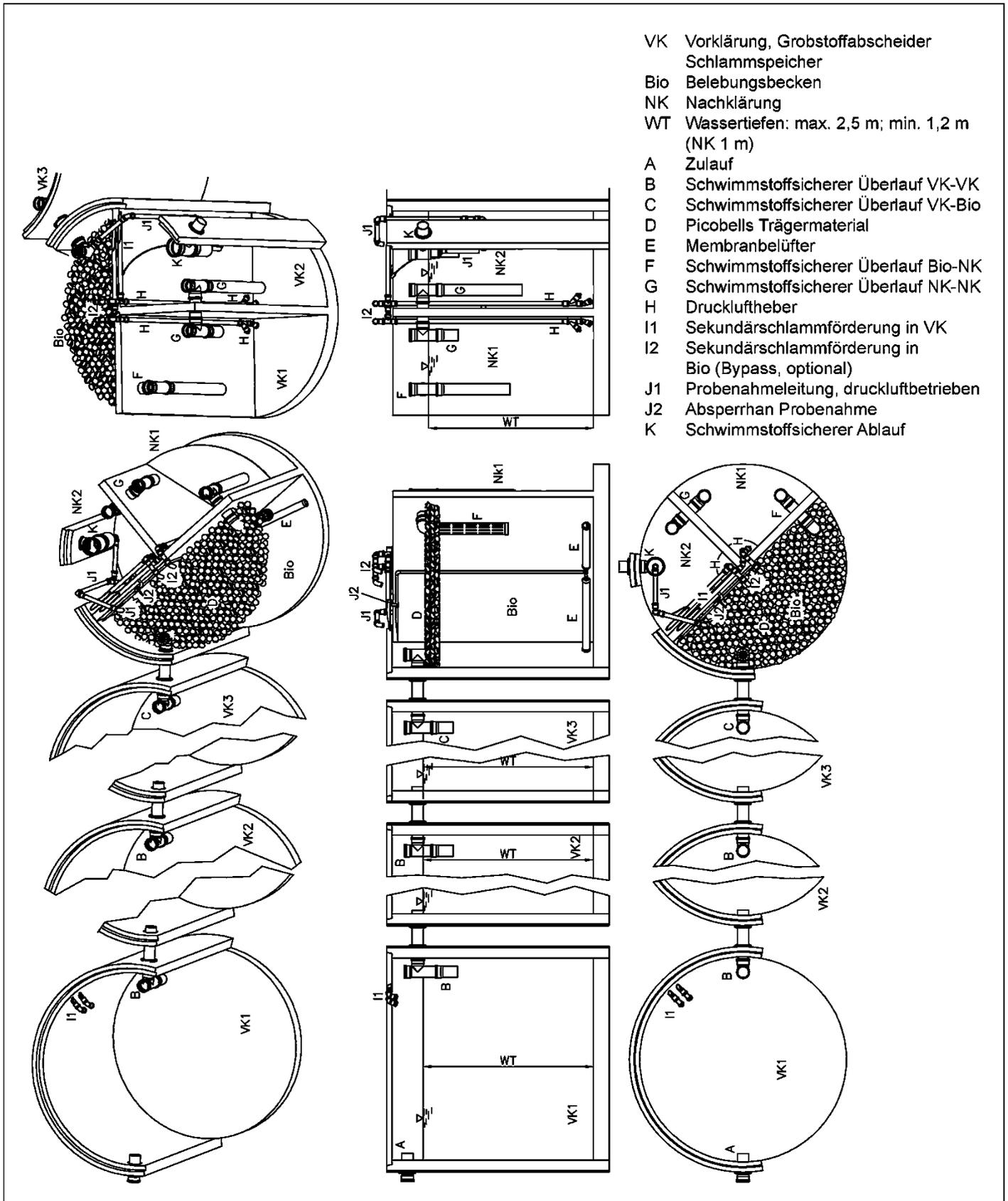
Nachrüstset Typ Picobells für den Einbau in bestehende Abwasserbehandlungsanlagen zur Herstellung von Kleinkläranlagen für 4 bis 50 EW; Ablaufklasse C
