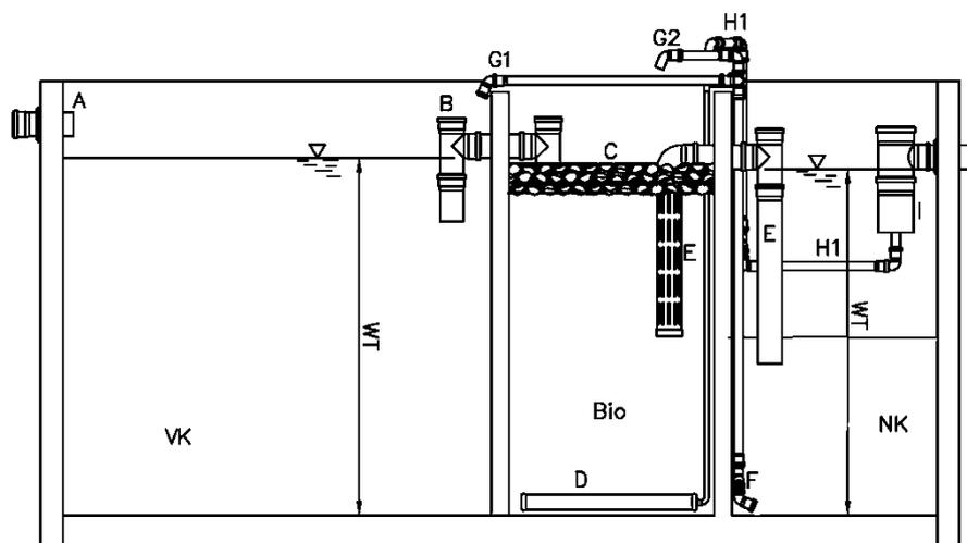
Nachrüstatz Typ Picobells für den Einbau in bestehende Abwasserbehandlungsanlagen zur Herstellung von Kleinkläranlagen für 4 bis 50 EW; Ablaufklasse C
