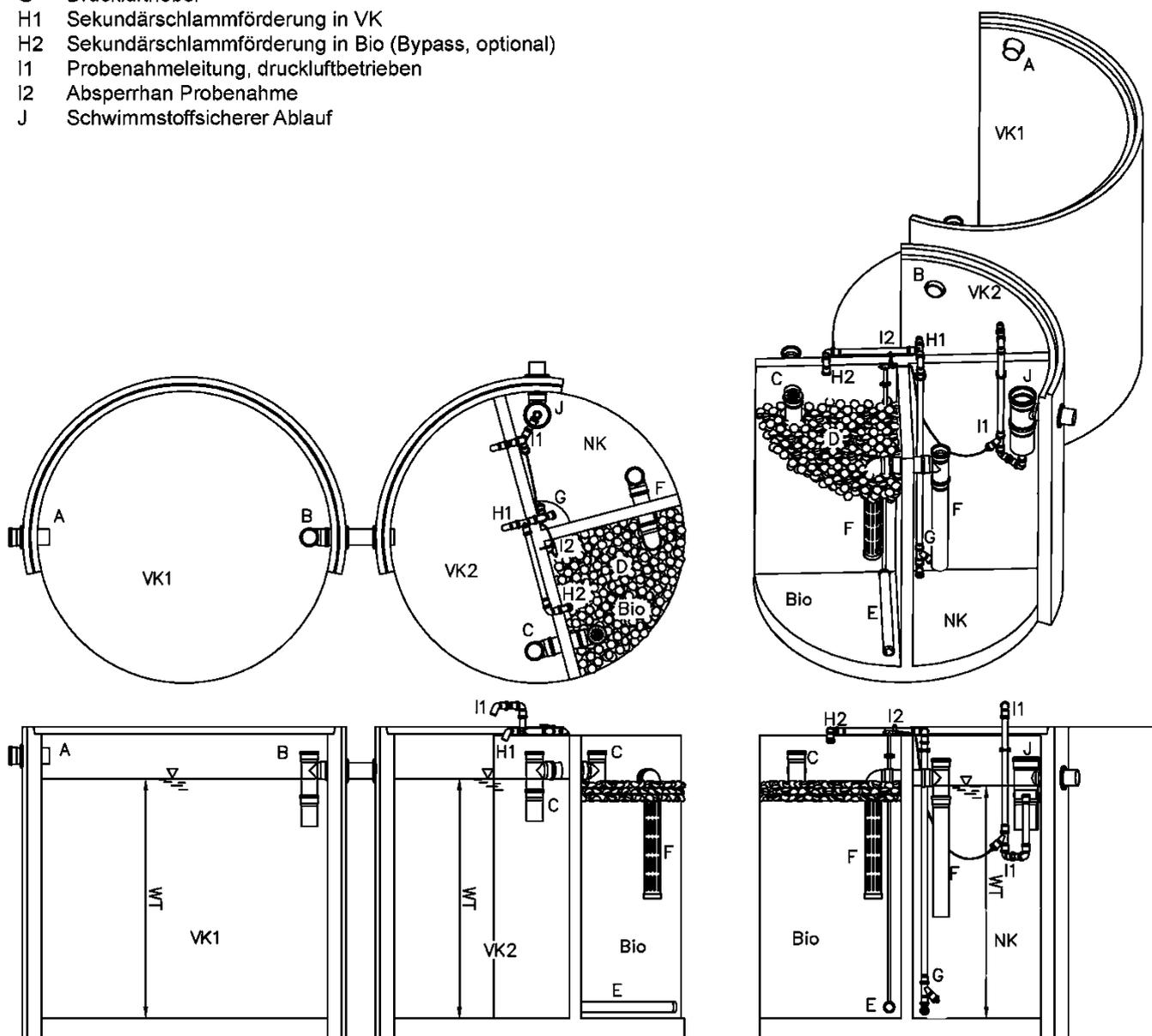
Nachrüstset Typ Picobells für den Einbau in bestehende Abwasserbehandlungsanlagen zur Herstellung von Kleinkläranlagen für 4 bis 50 EW; Ablaufklasse C
