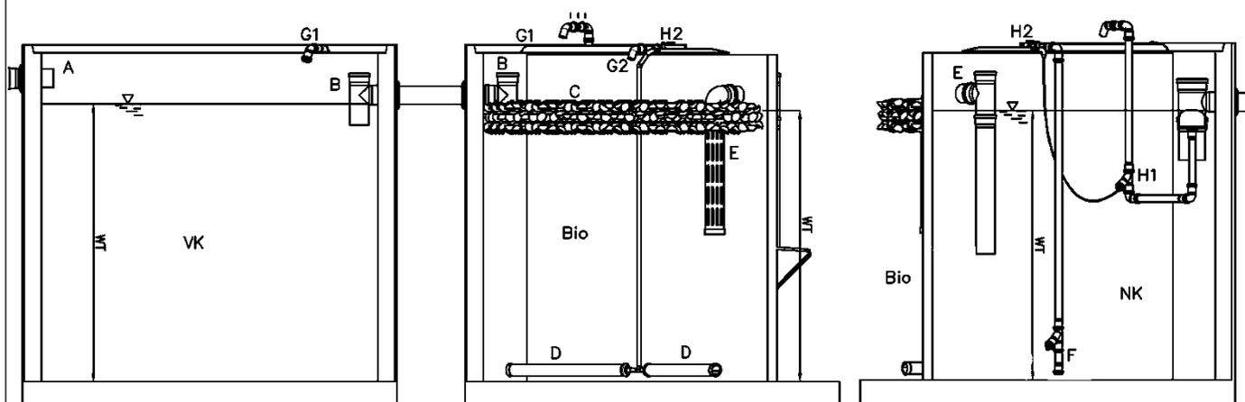
Nachrüstatz Typ Picobells für den Einbau in bestehende Abwasserbehandlungsanlagen zur Herstellung von Kleinkläranlagen für 4 bis 50 EW; Ablaufklasse C
