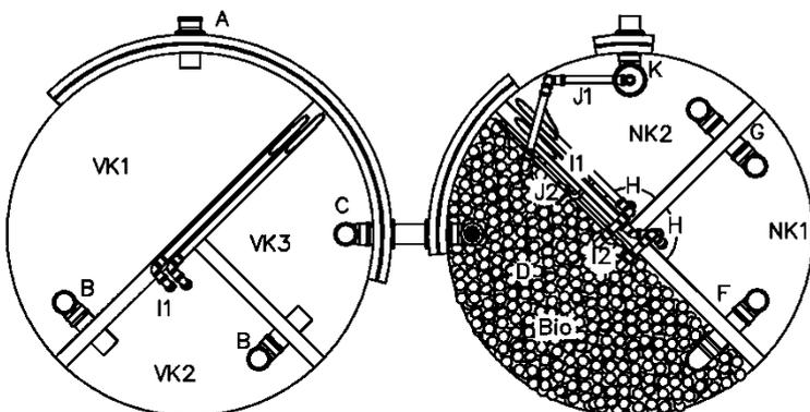
Nachrüstatz Typ Picobells für den Einbau in bestehende Abwasserbehandlungsanlagen zur Herstellung von Kleinkläranlagen für 4 bis 50 EW; Ablaufklasse C
