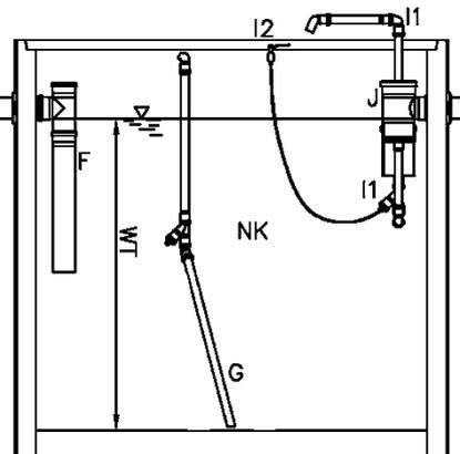
Nachrüstatz Typ Picobells für den Einbau in bestehende Abwasserbehandlungsanlagen zur Herstellung von Kleinkläranlagen für 4 bis 50 EW; Ablaufklasse C
