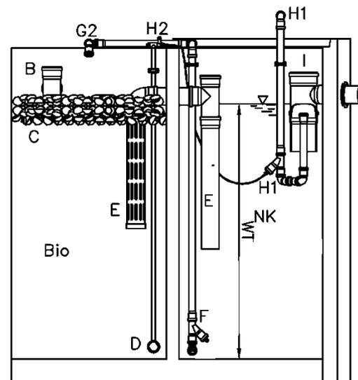
Nachrüstatz Typ Picobells für den Einbau in bestehende Abwasserbehandlungsanlagen zur Herstellung von Kleinkläranlagen für 4 bis 50 EW; Ablaufklasse C
