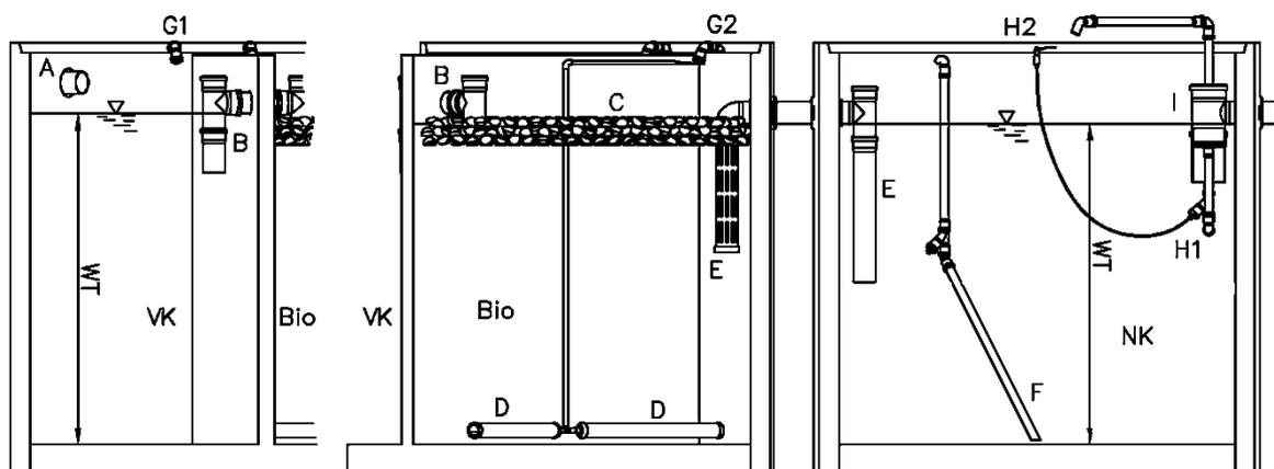
Nachrüstatz Typ Picobells für den Einbau in bestehende Abwasserbehandlungsanlagen zur Herstellung von Kleinkläranlagen für 4 bis 50 EW; Ablaufklasse C
